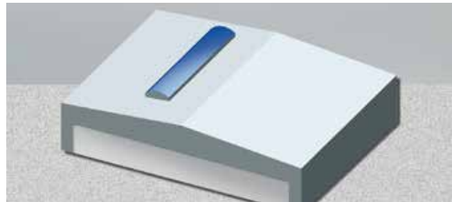
Kivitel: felülvilágítás lapos dőlésszögű tetőn át
