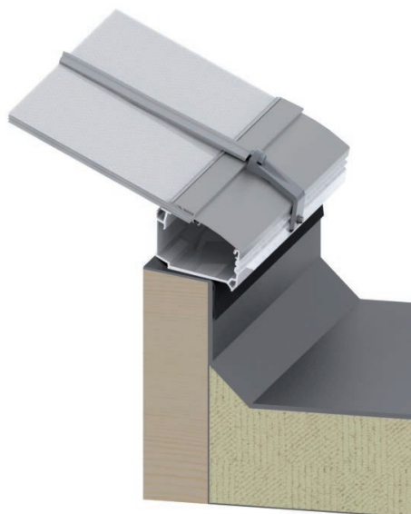
szerelés ragasztott fa födemelemre
