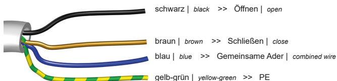
Anschlussschema Connection diagram
